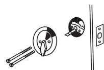
Assurez-vous que le pêne dormant est en position non-verrouillée. Placez l'assemblage de bouton-pousier sur la lame de torsion et alignez les trous de vis. Le bouton-pousier doit être en position verticale afin que vous puissiez voir les trous de vis. Fixez-le en place à l'aide des vis à métaux.
