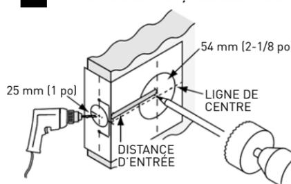
Percez des avant-trous de 3 mm (1/8 po) selon les marques tracées lors de l'étape précédente pour les trous de 25 mm (1 po) et de 54 mm (2-1/8 po).
