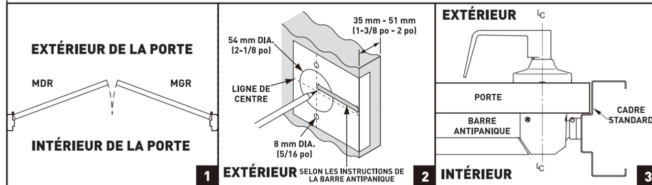
1. Suivez les instructions de perçage sur le gabarit. Percez des trous de 54 mm (2-1/8 po) sur les faces intérieure et extérieure de la porte.
