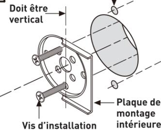
Coupez la queue, si nécessaire, de façon à ce qu'il y ait une projection de 4,5 mm (3/16 po) au-delà de la face intérieure de la porte.
